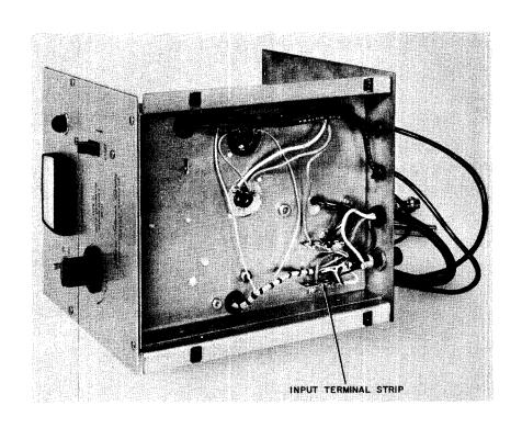
FIGURE 3. INPUT TERMINAL STRIP
